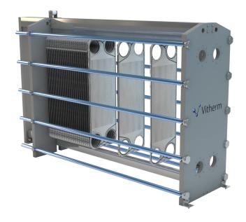
Промышленная серия **Vitherm** — это разборные пластинчатые теплообменники с фланцевыми соединениями. Пакет пластин, обычно изготовленных из нержавеющей стали, помещается между двумя прижимными плитами из углеродистой стали. Подвижная плита при помощи ролика перемещается по верхней направляющей и прижимается несколькими стяжными шпильками для обеспечения герметичности аппарата.
